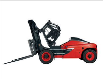
Eğilebilir kabin üzerinden motor erişimi
