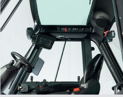
Güçlendirilmiş cam tavan
