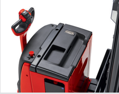
Bütün kontroller kolayca kumanda kolu üzerinden yapılır
