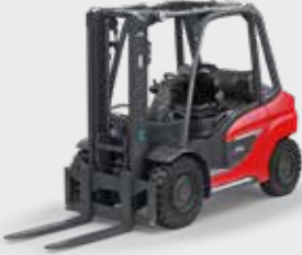
H35 - H50 Dizel ve LPG Motorlu Forklift Yük Kapasitesi: 3,5 t - 5,0 t
